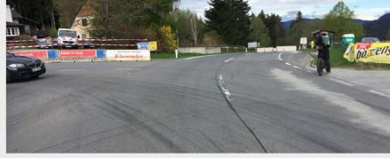
90 derece dönüşte yeterli kaçış yolu ve bariyerler
